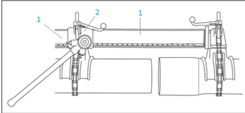
1 - TORNO ACOPLADOR P/PVC PPJ 04446 - 04446 – MARCA: REED
